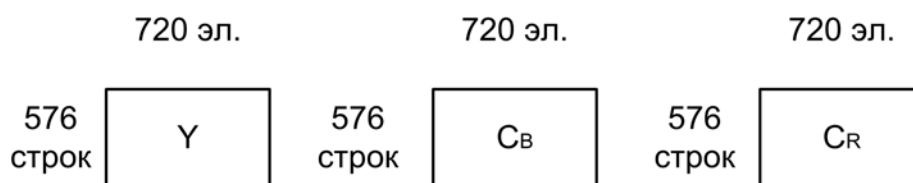
Рис. 7.5. Кодирование компонентного видеосигнала (4:4:4)
